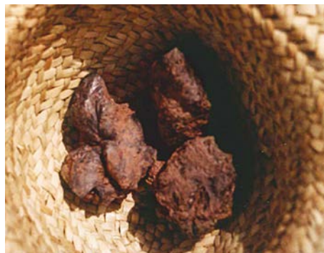
Les pierres de limonite sont composées d'oxydes de fer.
