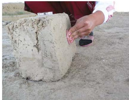
Le test à l'éponge permet d'évaluer la sensibilité à l'eau des enduits en terre sur des surfaces verticales et horizontales
