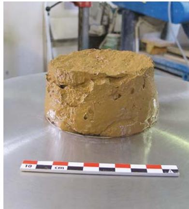
L'étalement d'un mortier frais, par la mesure de la différence de diamètres de la pâte entre avant (a) et après (b) l'application de quinze chocs permet d'en évaluer l'ouvrabilité.
