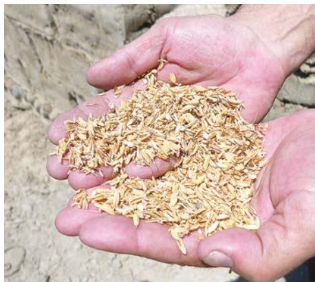
La balle de riz est utilisée dans la préparation de l'enduit de protection en terre.
