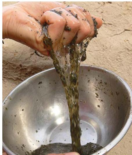
L'eau devient instantanément gluante au contact des feuilles *fouga* : il se forme un gel, véritable colle des argiles.
