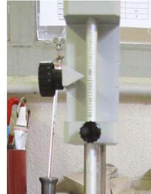
La consistance d'un mortier s'évalue par la méthode du cône de pénétration. La mesure de la profondeur de pénétration du cône dans la pâte permet d'évaluer cette consistance et de comparer l'impact de l'ajout de stabilisant.
