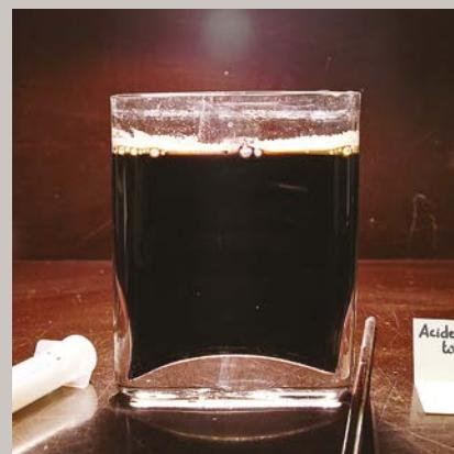
L'encre métallogallique est fabriquée à partir de tannin (ici du tannin en poudre) et de fer (ici, inséré à la seringue, le jus de clous restés longtemps dans du vinaigre). Lorsque les tanins sont au contact des ions ferriques, ils forment des complexes, facilement identifiables par leur opacité et leur couleur noire.
