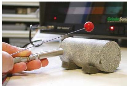
L'impulsion appliquée à l'aide du marteau sur le matériau le fait vibrer. L'enregistrement de cette vibration avec un micro adapté permet, par un calcul, d'obtenir les caractéristiques élastiques de ce matériau.
