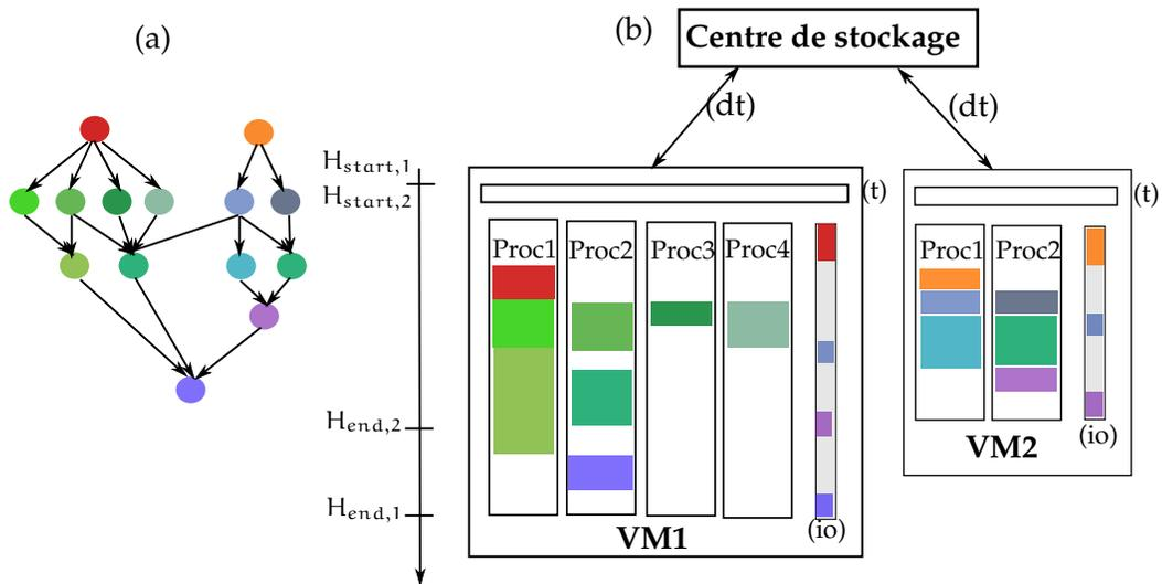
FIGURE 1 – Workflow (a) et plateforme (b) : machines virtuelles (VM), leurs processeurs (Proc1 à Proc4), leur temps de transfert de fichiers (io), leur temps de démarrage (t) de durée  $d_{ini}$ , leurs interactions avec le centre de stockage commun (dt)
