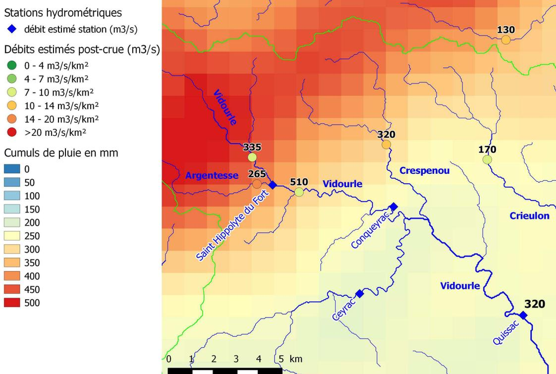
**Figure 4. Estimations des débits de pointe disponibles dans le bassin amont du Vidourle (enquête post crue et stations hydrométriques). Les débits estimés sont indiqués en étiquettes. Les cumuls de pluie présentés sont donnés à titre indicatif et concernent la période du 15/9 06:00 au 20/09 06:00.**
