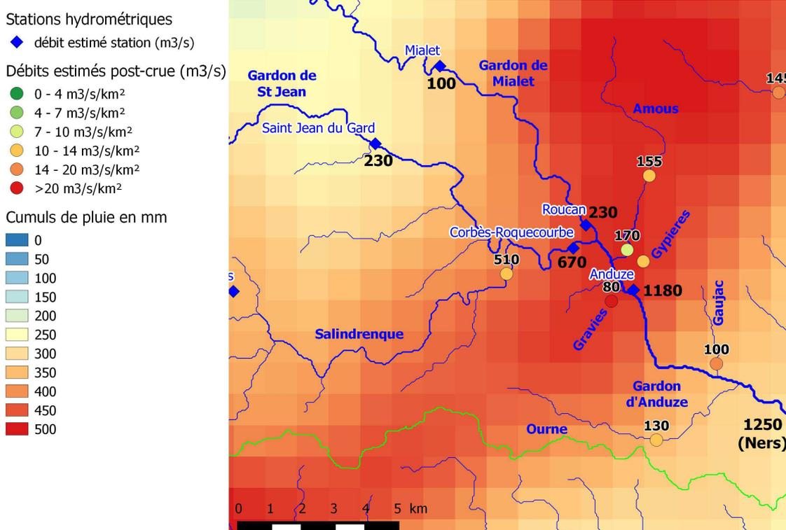
**Figure 5. Estimations des débits de pointe disponibles dans le bassin aval du Gardon d'Anduze (enquête post crue et stations hydrométriques). Les débits estimés sur l'Amous correspondent à la crue du 20/9. Les cumuls de pluie présentés sont donnés à titre indicatif et concernent la période du 15/9 06:00 au 20/09 06:00.**
