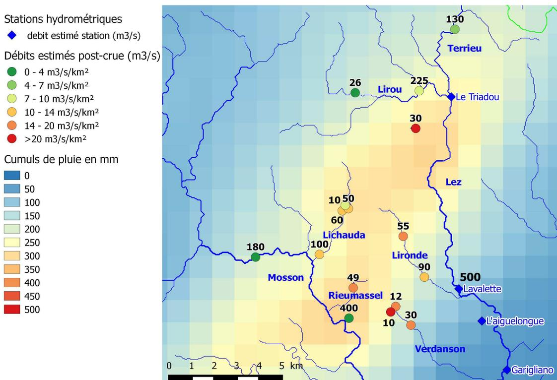
Figure 10. Estimations des débits de pointe disponibles dans les bassins du Lez amont et de la Mosson (enquête post crue et stations hydrométriques). Les débits estimés sont indiqués en étiquettes. Les cumuls de pluie présentés concernent la période du 06/10 06:00 au 15/10 00:00.
