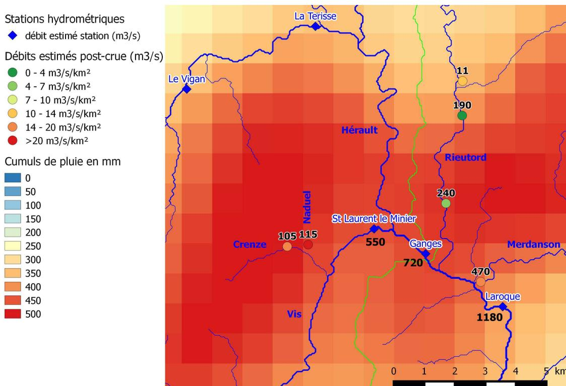
**Figure 3. Estimations des débits de pointe disponibles dans le bassin amont de l'Hérault (enquête post crue et stations hydrométriques). Les débits estimés sont indiqués en étiquettes. Les cumuls de pluie présentés sont donnés à titre indicatif et concernent la période du 15/9 06:00 au 20/09 06:00.**
