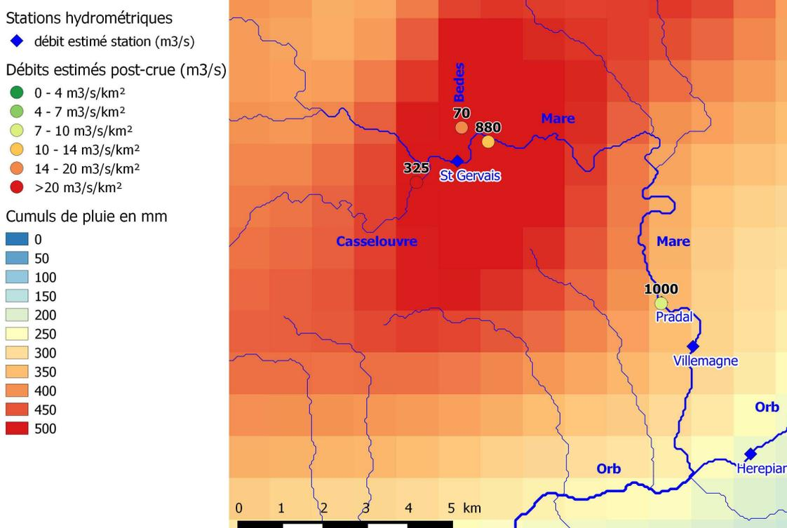
**Figure 2. Estimations des débits de pointe disponibles dans le bassin de la Mare (enquête post crue et stations hydrométriques). Les débits estimés sont indiqués en étiquettes. Les cumuls de pluie présentés sont donnés à titre indicatif et concernent la période du 15/9 06:00 au 20/09 06:00.**
