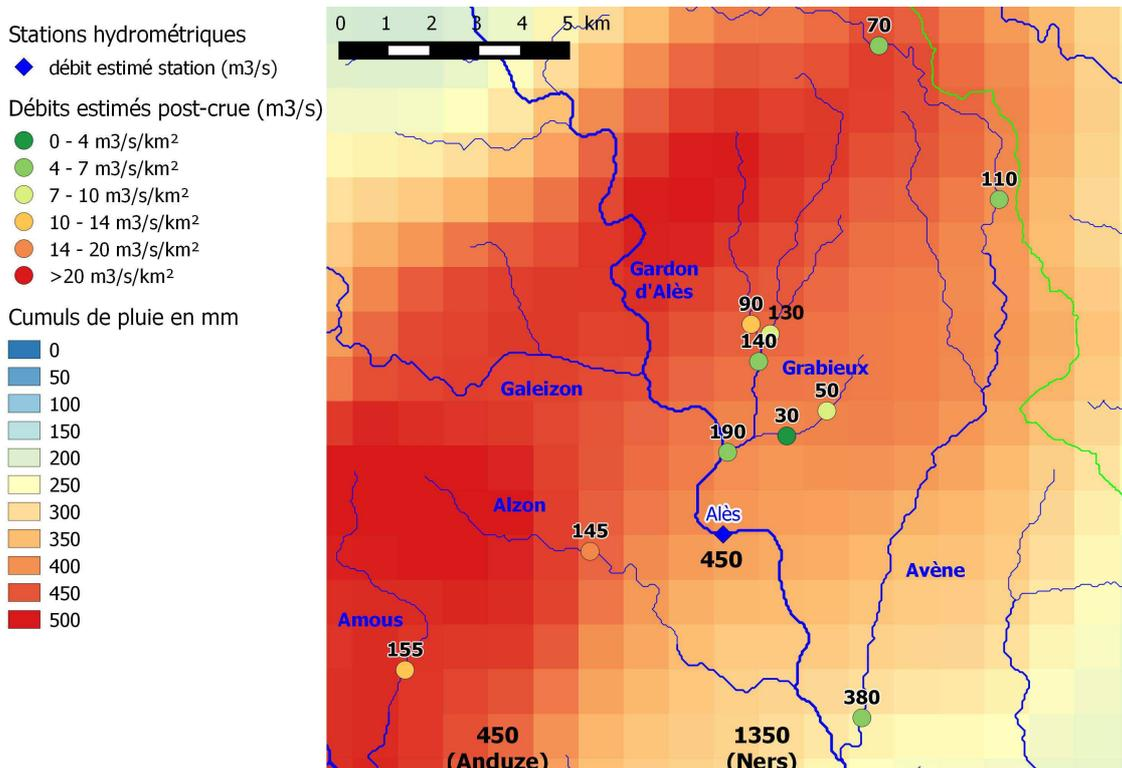
**Figure 6. Estimations des débits de pointe disponibles dans le bassin aval du Gardon d'Alès (enquête post crue et stations hydrométriques). Les débits estimés sont indiqués en étiquettes. Les cumuls de pluie présentés sont donnés à titre indicatif et concernent la période du 15/9 06:00 au 20/09 06:00.**
