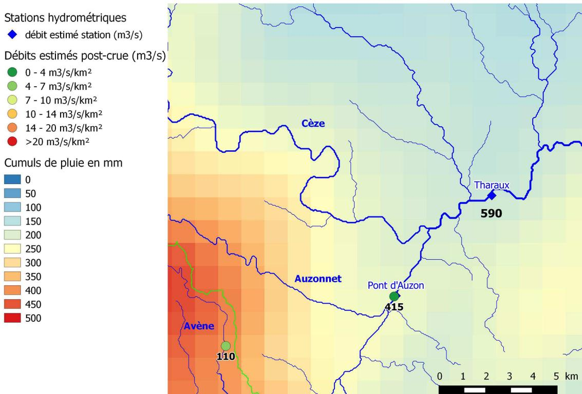
**Figure 7. Estimations des débits de pointe disponibles dans le bassin intermédiaire de la Cèze (enquête post crue et stations hydrométriques). Les débits estimés sont indiqués en étiquettes. Les cumuls de pluie présentés concernent la période du 15/9 06:00 au 20/09 06:00.**
