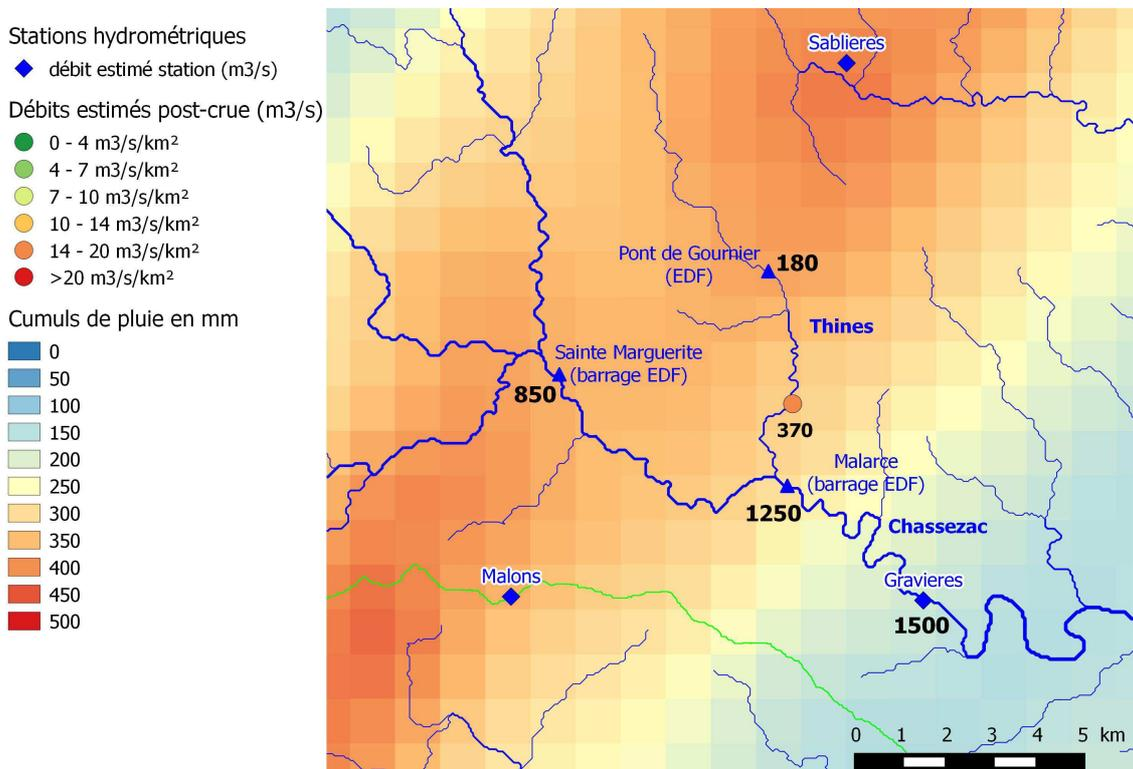
**Figure 8. Estimations des débits de pointe disponibles dans le bassin intermédiaire du Chassezac (enquête post crue, stations hydrométriques, et ouvrages). Les débits estimés sont indiqués en étiquettes. Les cumuls de pluie présentés concernent la période du 15/9 au 20/09 06:00.**
