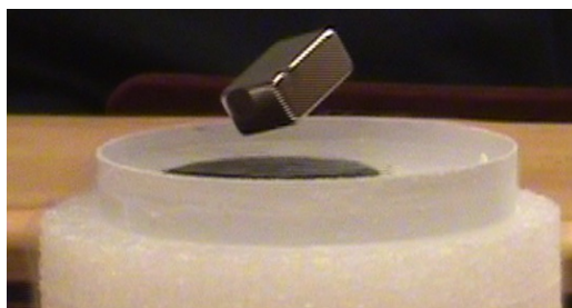
FIGURE 3 – La lévitation magnétique. La pastille noire posée dans la coupole est un supraconducteur refroidi par de l'azote liquide. Un aimant est approché : il est repoussé par la pastille et flotte à quelques millimètres au-dessus du support.
