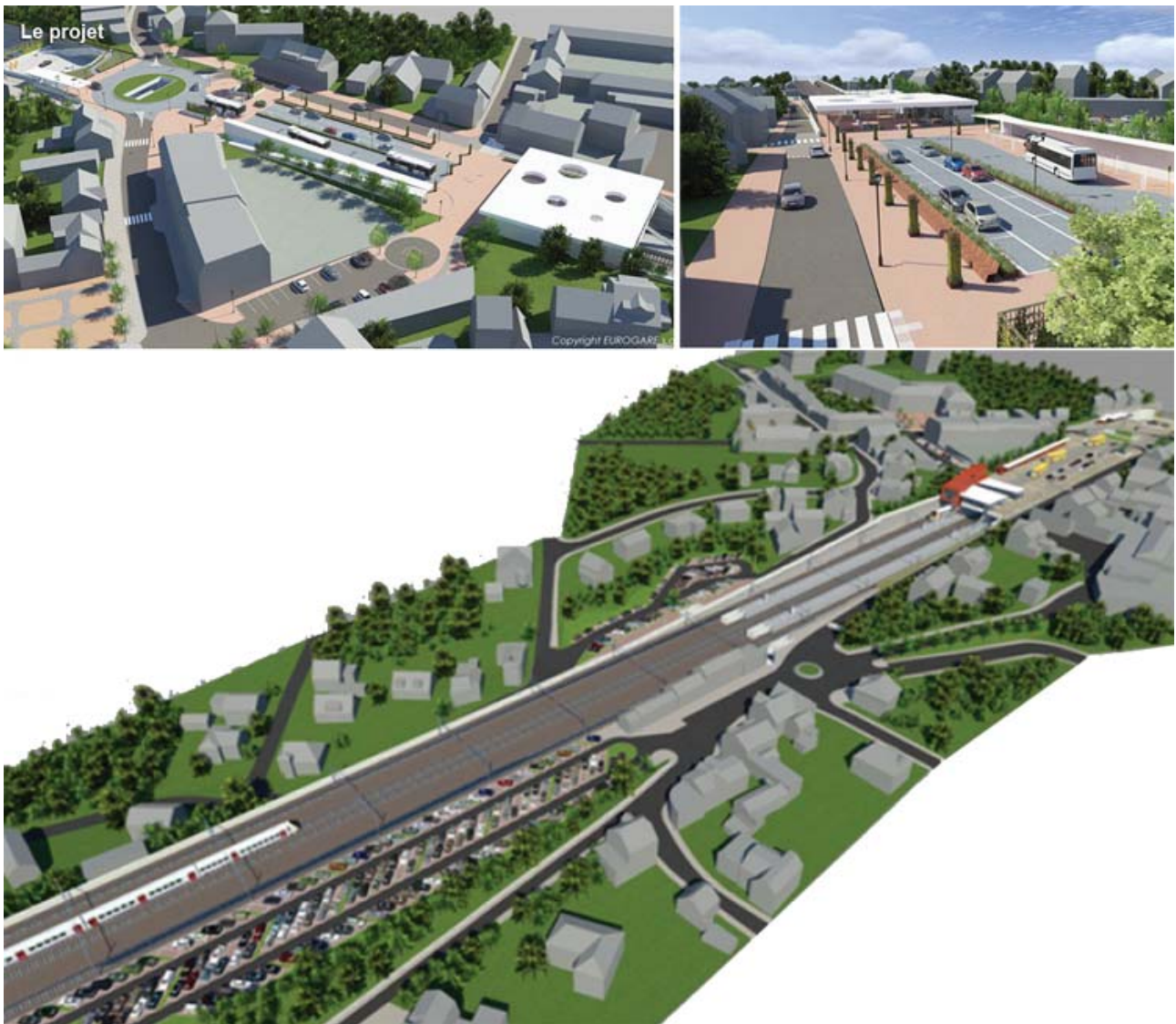
Axonométries de l'aménagement des abords de la gare de Rixensart : aménagement "routier" et technique de la dalle, présentée par ses concepteur comme une "place de village". (Source : Infrabel)
