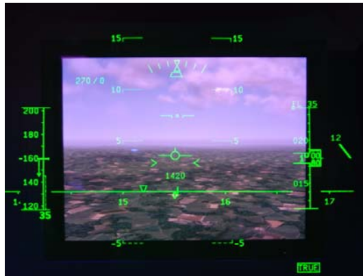
Figure 4. Exemple d'HUD développé par la firme Thales, équipant l'avion militaire A400M
