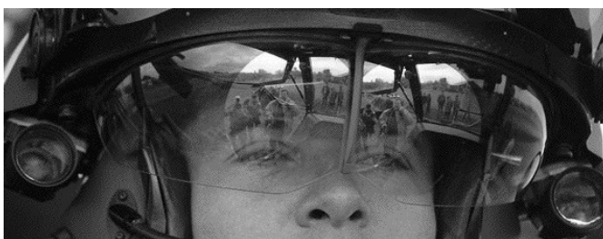
Figure 8. Système TopOwl (Thales) ; on remarque le combineur visière et les tubes de vision de chaque côté du casque, au niveau de la ligne des yeux
