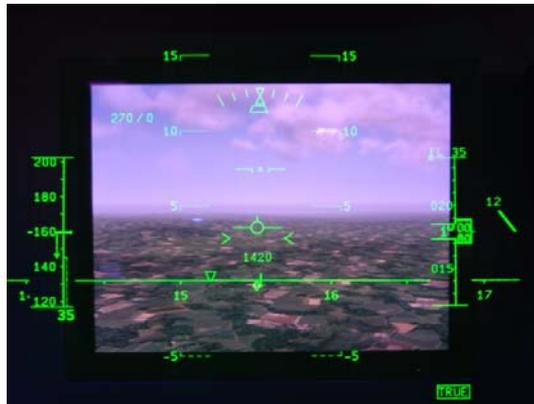
**Figure 4.** *Exemple d'HUD développé par la firme Thales, équipant l'avion militaire A400M*
