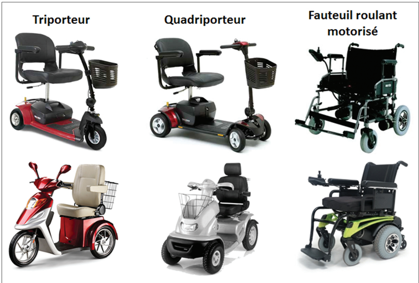
Fig. 1 Les trois types d'AMM : triporteur, quadriporteur et fauteuil roulant motorisé
