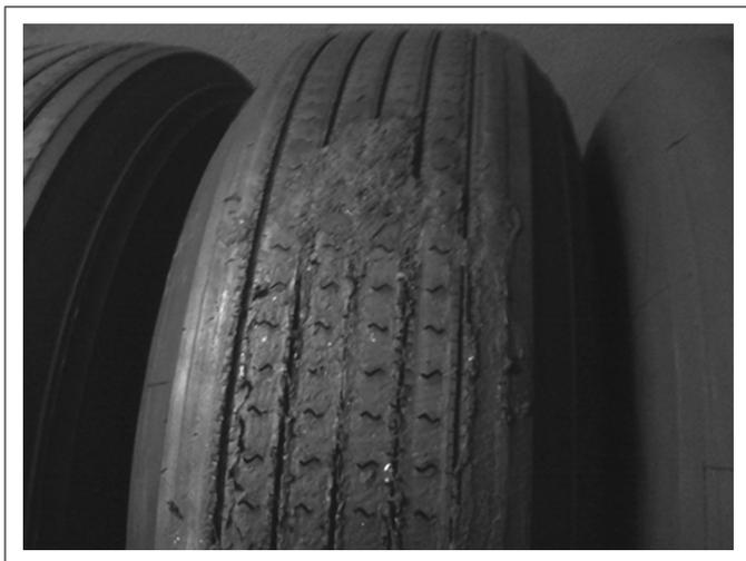
**Fig. 1** Détérioration sur pneumatique freiné sans rotation
