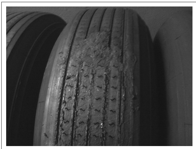
Fig. 1 Détérioration sur pneumatique freiné sans rotation
