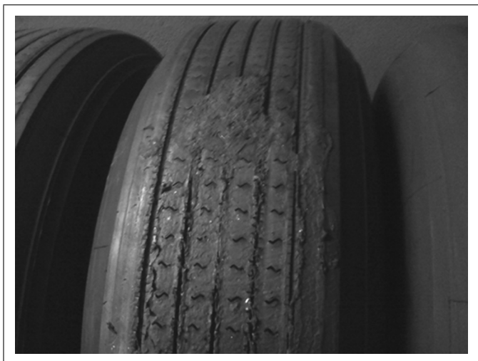
Fig. 1 Détérioration sur pneumatique freiné sans rotation
