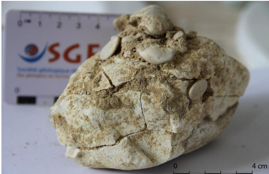
Fig. 21 : Galet de craie injecté de sable, aux abords d'une faille inverse (fig. 5 et 14). Fig.21: Chalk pebble of sand-injected, near an opposite fault (fig. 5 and 14).
