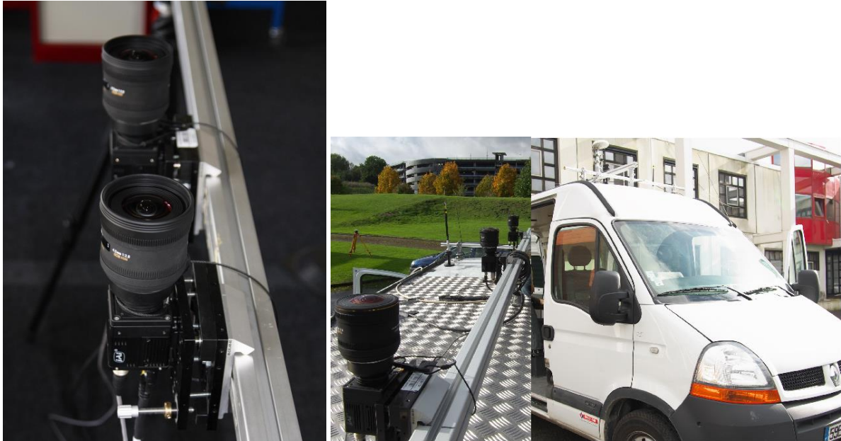
Figure 7. Caméras utilisées pour le système stéréoscopique et système déployé sur le véhicule
