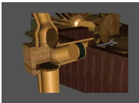
Figure 2 - Lorsque la bielle part vers l'arrière, la soupape du tuyau d'aspiration (en bas sur l'image) s'ouvre, l'eau monte. Le mouvement vers l'avant de la bielle repousse l'eau, la soupape du bas se referme, celle du tuyau d'élévation s'ouvre et laisse passer l'eau.
