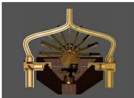
Figure 1 - Le mouvement de va-et-vient des pistons à l'intérieur des deux cylindres horizontaux est obtenu par un système de bielle manivelle entraîné par une succession de roues dentées engrenées. La roue verticale est entraînée par le courant de l'eau qui est puisée pour être élevée.
