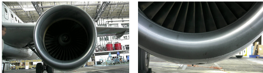
Figure 19. La caractérisation des défauts sur des zones fortement courbées reste problématique (exemple du bord d'attaque d'une entrée d'air de réacteur)
