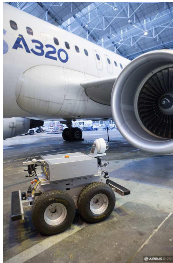
Figure 1. Air-Cobot en train d'inspecter un A320
