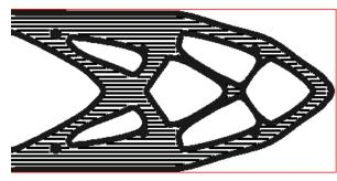
(d) 'Crust-pattern' model with isotropic crust and anisotropic infill
