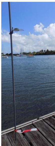
Photo 5. Hydrogrouette en acier galvanisé, avec la boussole placée sur un dispositif coulissant
