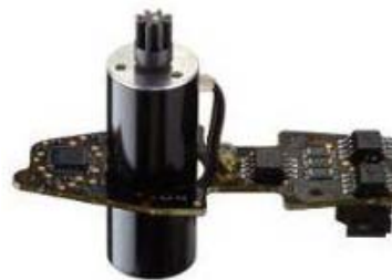
Figure 16 : Photo u moteur brushless et de son électronique
