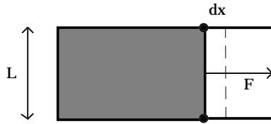
Figure 1. Film de savon suspendu sur un cadre solide dont un côté, de longueur L , est mobile. La force F est la force qu'il faut appliquer sur ce côté pour le maintenir fixe. [Soap film on a rigid frame with a mobile side (length L ). A force F must be applied to maintain this side at rest.]
