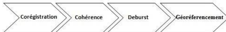
Figure 2. Les étapes de calcul de la cohérence interférométrique : 1-Corégistration, 2-Calcul de cohérence, 3-Deburst, et 4-Correction terrain (TC)
