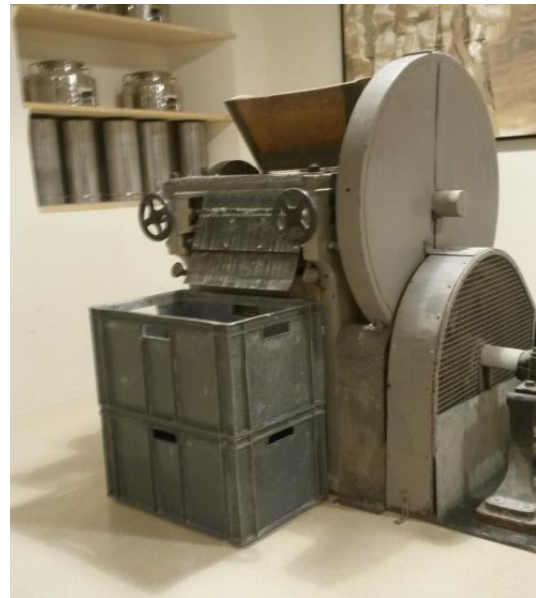
Broyeur à cylindres
