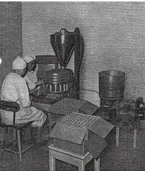
Homogénéisation et remplissage des tubes de pommades.
