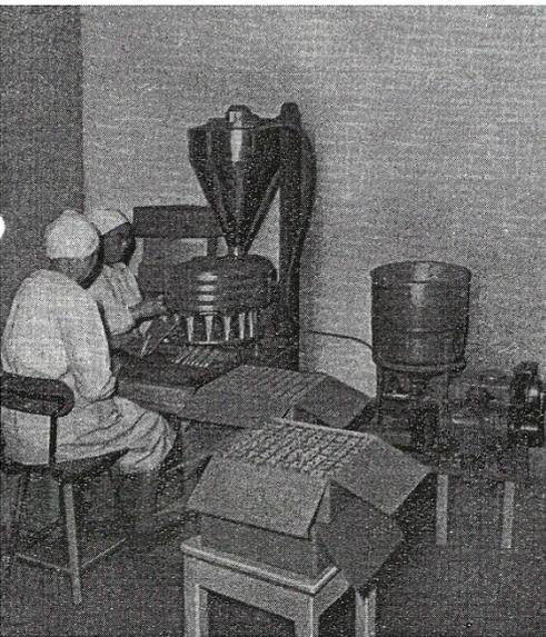
*Homogénéisation et remplissage des tubes de pommades.*
