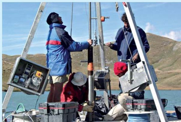
Carottage long en action sur le Lac d'arterne (2061m).
