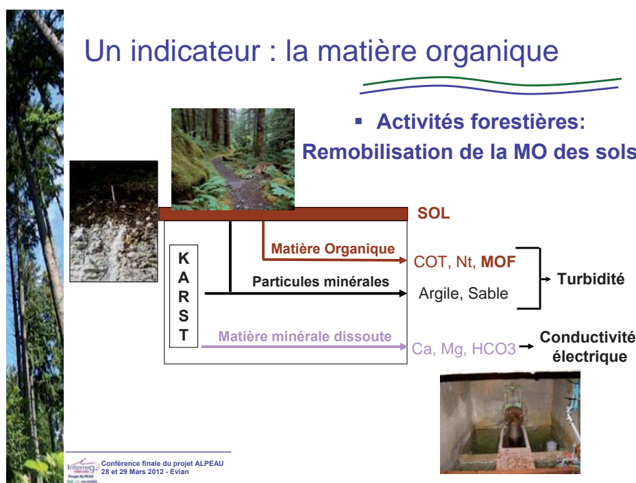
Figure 9 - Transferts possibles de matières naturelles depuis la surface jusqu'à l'émergence d'un système karstique. Le suivi de la matière organique fluorescente (MOF) a permis, ici, d'identifier les sources pédologiques ou hypogées mobilisées vers les eaux souterraines. Il apporte une information supplémentaire qui vient compléter celles obtenues par d'autres indicateurs plus classiques tels que le carbone organique total (COT), la conductivité des eaux ou leur turbidité. Les graphiques illustrent la spécificité du comportement des matières organiques de types humiques (HL) et protéiques (PL) par rapport aux autres indicateurs lors d'un suivi temporel des eaux à l'émergence d'un système karstique (Tissier et al., 2013).
