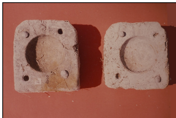
Figure 104 - Les deux coquilles du moule n°18 – diamètre du boulet : 65 mm
