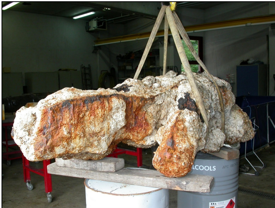
Figure 40 - Pièce Cn 13 à son arrivée au Laboratoire ARC' Antique, on distingue sur la droite de l'ensemble la culasse mobile, collée par la concrétion à la volée du canon.
