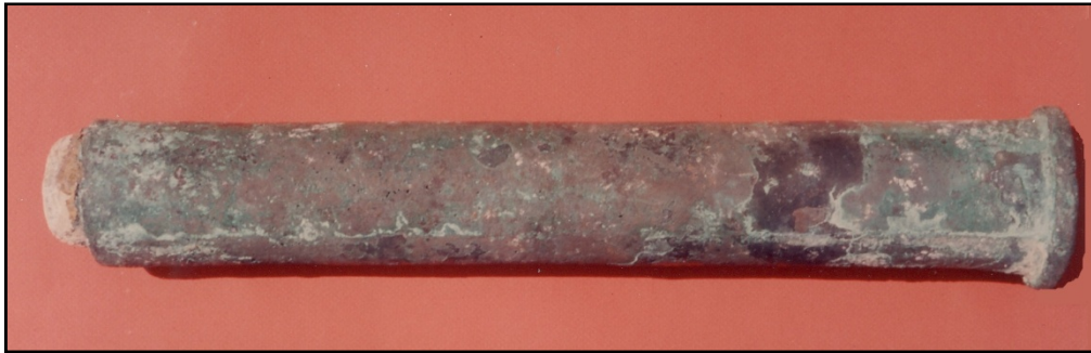
Figure 141 – Tube en alliage cuivreux, avec un boulet coincé dans la volée.
