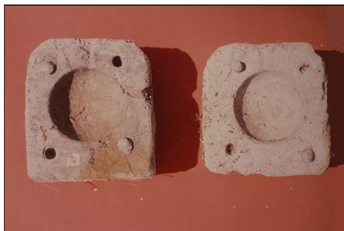
Figure 82 - Les deux coquilles du moule n°18 – diamètre du boulet : 65 mm
