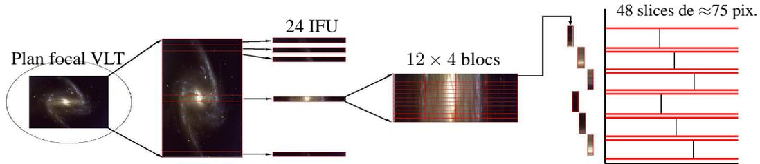
FIG. 2 – Schéma simplifié d’acquisition sur CCD de l’instrument MUSE
