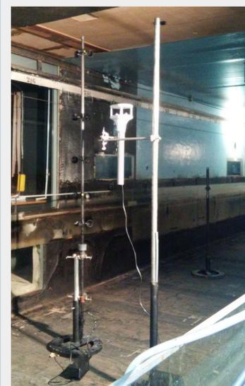
Illustration. Dispositif d'étalonnage des anémomètres à coupelles. Sur la photo, le centre de l'anémomètre de référence (Gill) est placé au niveau de l'hélice 4.
