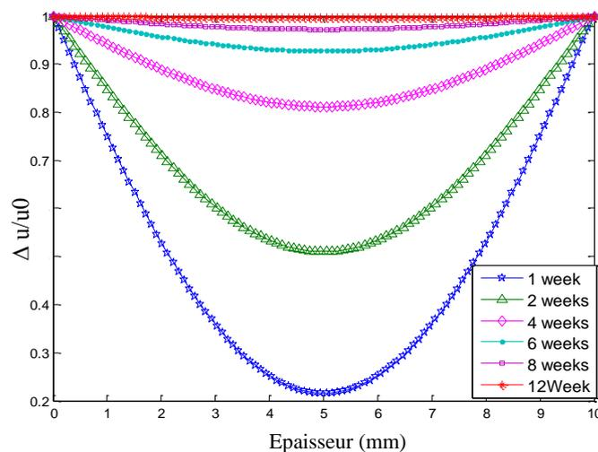
Fig. 4. La variation de la teneur en eau normalisé jusqu'à la saturation en immersion de la bande.
