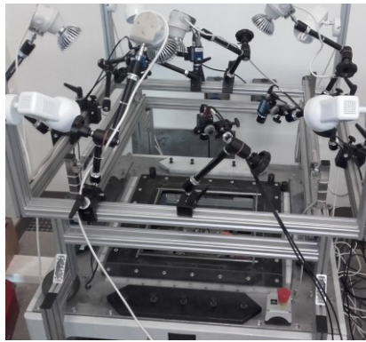
Fig. 3. Dispositif d'emboutissage de préformes textiles avec instrumentation par stéréo-corrélation
