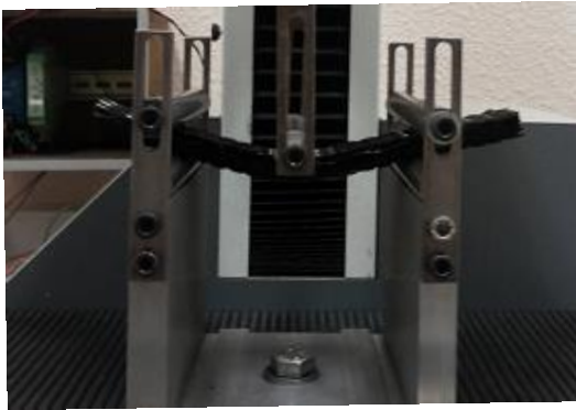
Fig. 6. Dispositif d'essai de flexion 3 points
