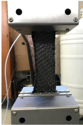
Fig. 4. Dispositif d'essai de bias-extension-test.
