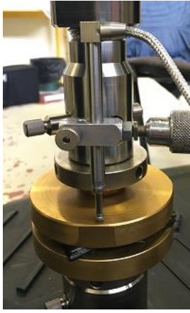
Fig. 1. Dispositif d'essai de compression.
