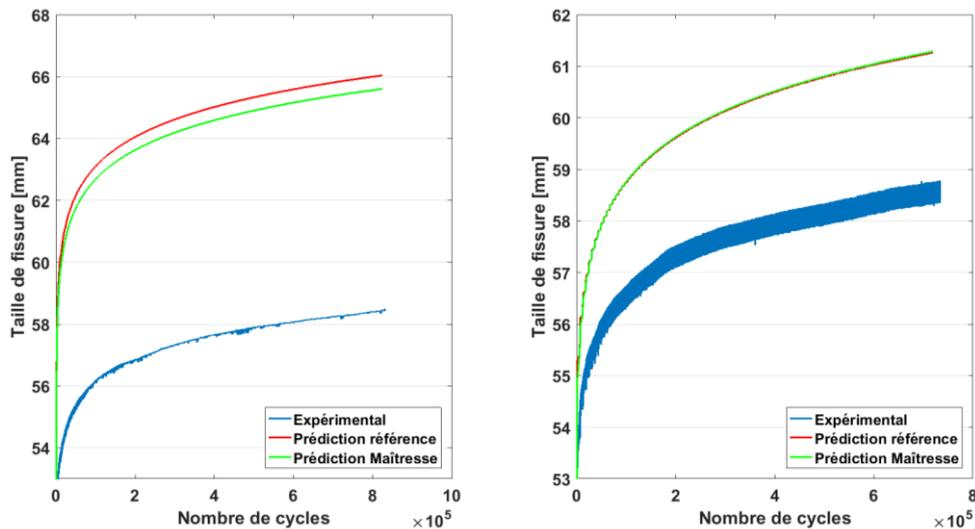
Fig. 8. Prédiction de la propagation du délaminage sous spectre de charge à rapport de charge variable et déplacement maximum constant pour les deux cas considérés : 2\*75blocs (gauche) et 2\*120 blocs (droite)
