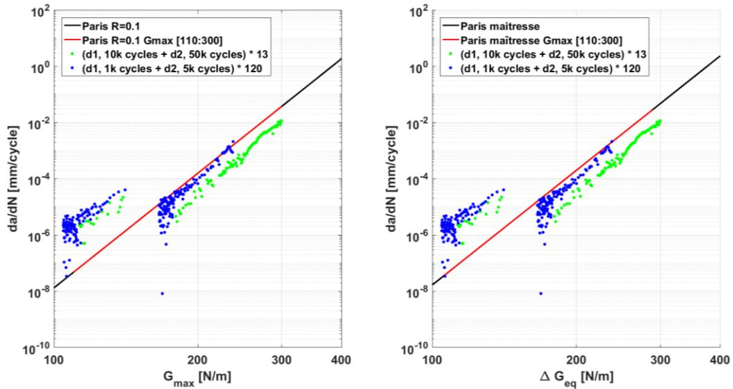
Fig. 4. Courbes de propagation pour un spectre complexe alternant des blocs à  $d_1$  et des blocs à  $d_2$  en fonction de  $G_{max}$  avec la droite de référence  $R=0,1$  (gauche) et  $\Delta G_{eq}$  avec la courbe maîtresse de propagation (droite)
