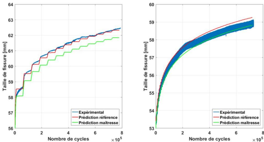
Fig. 5. Prédiction de la propagation du délaminage sous spectre de charge à rapport de charge constant et déplacement maximum variable pour les deux cas considérés :  $2*13$  blocs (gauche) et  $2*120$  blocs (droite)
