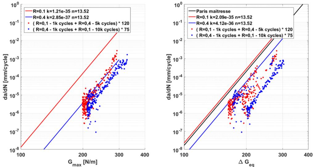
Fig. 7. Courbes de propagation de délaminage pour un spectre complexe alternant des blocs à  $R=0,1$  et des blocs à  $R=0,4$  en fonction de  $G_{max}$  avec les droites de référence (gauche) et  $\Delta G_{eq}$  avec la courbe maîtresse (droite)
