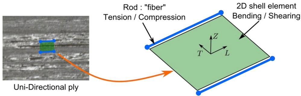
Fig. 2. Principe de modélisation Semi-Continue d'un pli UD
