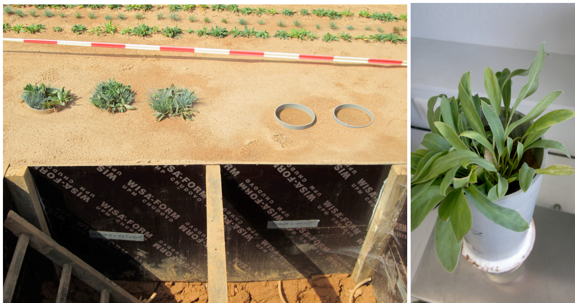
Figure 1 : a) Photo des lysimètres de terrain b) Photo d'une colonne de laboratoire végétalisée avec Anthyllis .
