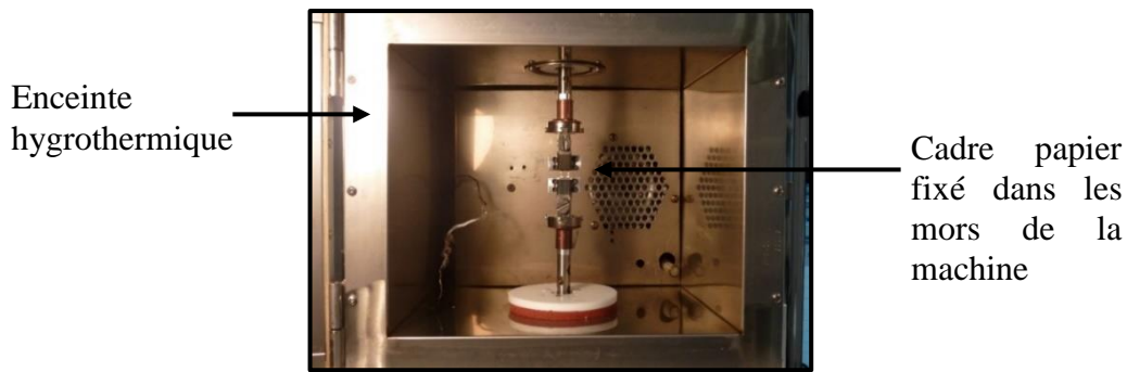
Fig. 4. DMA avec montage des fibres pour essais de traction.
