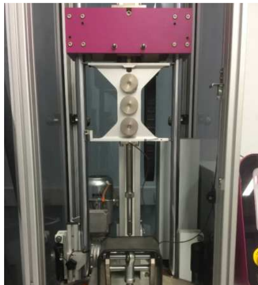
Fig 1. Machine d'impact Ceast avec une masse 5.2Kg. L'impact à lieu dans une zone circulaire encastrée sur son contour
