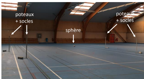
Figure 8. Sphère soutenue par des fils à 4 poteaux
