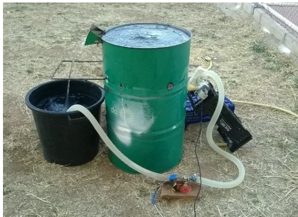
Fig. 1. Máquina de flotar construida ad hoc.
