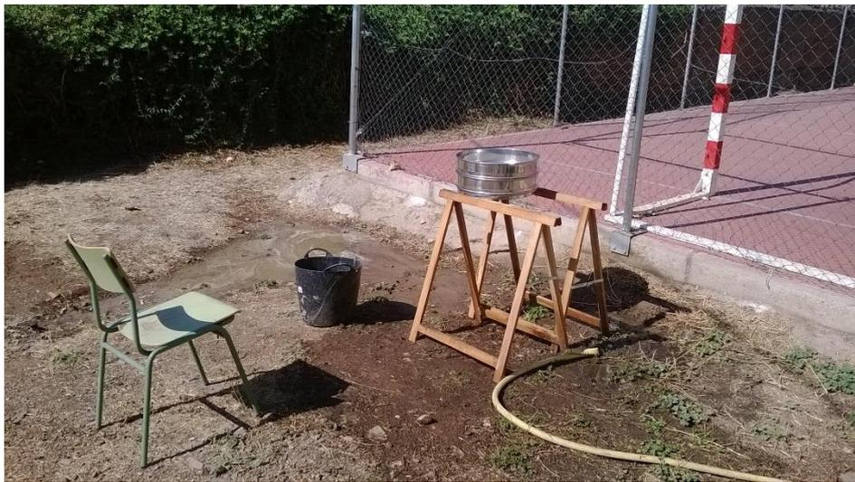
**Fig. 4.** Puesto de criba bajo el agua sobre una colona de cribas.
