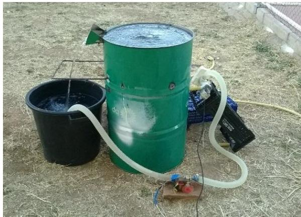
**Fig. 1.** Máquina de flotar construida ad hoc.
