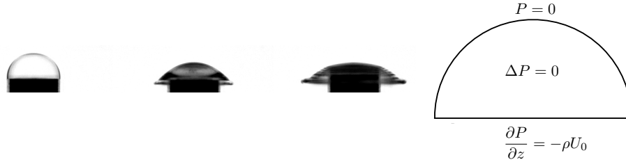
FIGURE 1 – À gauche : séquence montrant l'écoulement après impact pour une goutte de 2 millimètres de rayon et une hauteur de chute de 7 centimètres. L'écart de temps entre chaque images est de 8,3 \cdot 10^{-5} secondes. À droite : modélisation de l'impact d'une demi-goutte de rayon R . Ce problème est régi par une équation de Laplace avec la condition de Dirichlet P = 0 sur la surface libre et la condition de Neumann \frac{\partial P}{\partial z} = -\rho U_0 sur le support.
