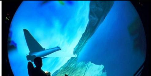
*L'écran est un dôme de 6 mètres de large monté verticalement, donnant un authentiques 180° d'ouverture dans les deux plans verticaux et horizontaux.*
