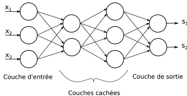
Figure 4 Exemple d'architecture de reseau de neurones
