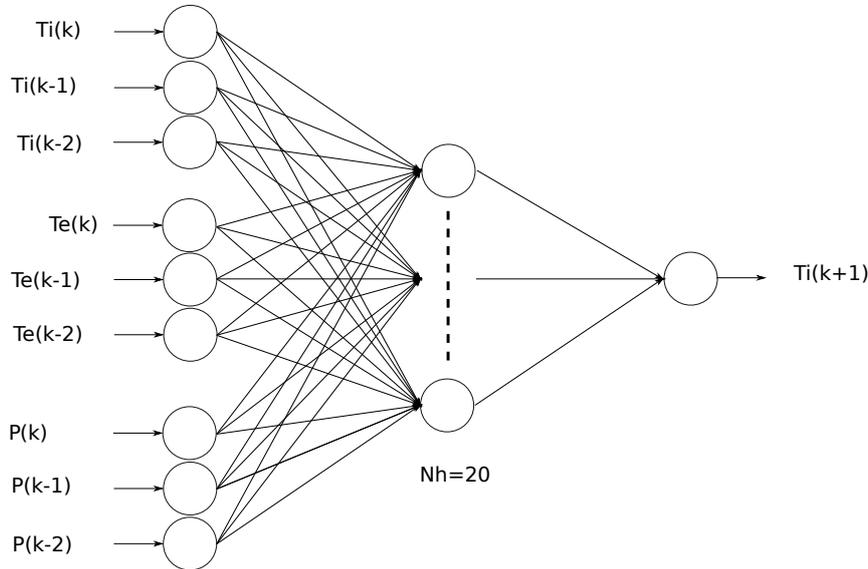
Figure 5 Architecture du réseau de neurones
