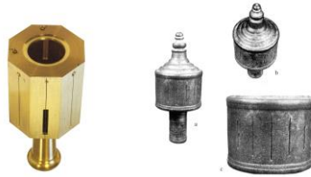
Fig. 5 : Equerres d'arpenteur moderne (à gauche ; photo Ph. Fleury) et antique (à droite ; photo P. Druelle).
