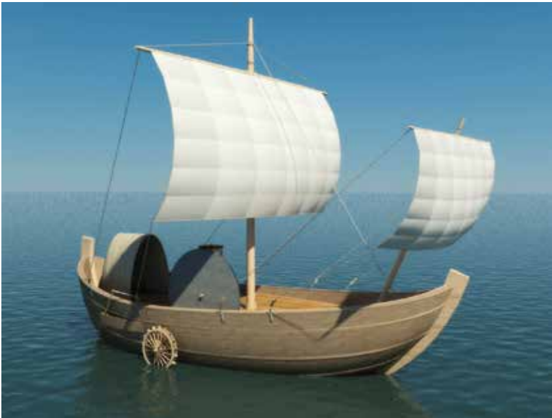
Fig. 3 – L'hodomètre marin décrit par Vitruve au I er siècle a.C. (UCBN – Plan de Rome, France)
