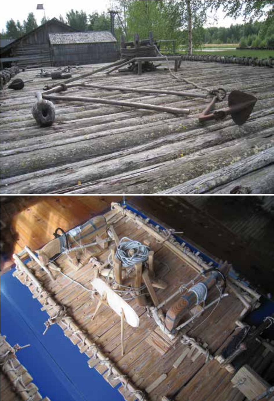
Fig. 9 – Radeau avec cabestan mû par des chevaux – détail et maquette (Finlande, Pielisen Museo – Lieksa; cliché P. Fleury)
