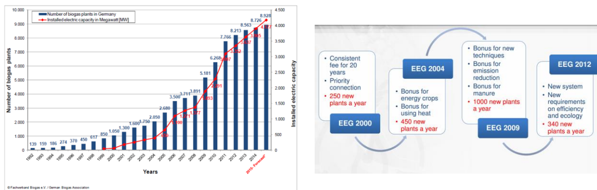
Figure 6.4.7. Évolution en Allemagne du contexte réglementaire et du nombre d'installations de biogaz et de la puissance électrique associée (Fachverband Biogas, 2014) 14
