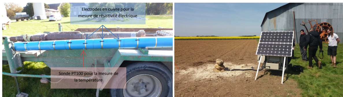
Figure 8 : Photographie du dispositif géophysique en forage : à gauche tube équipé des électrodes et des sondes de température avant installation, à droite : dispositif après installation avec sa station de pilotage autonome
