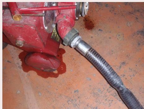
**Limiter notamment l'oxygénation du vin en fin de tirage due à la purge du circuit de la cuve jusqu'au camion**
